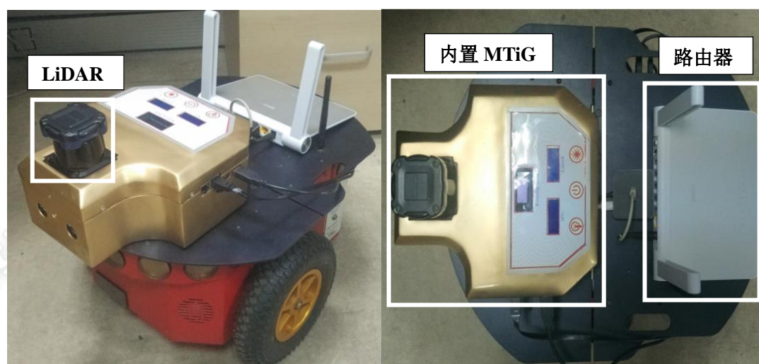
图 5-1 组合系统的 UGV 硬件平台
