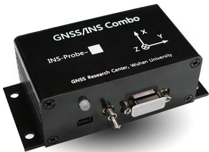
INS-Probe是一款低成本高精度MEMS组合导航系统，内置单频GNSS接收机模组、MEMS惯导、磁力计和气压计，可以输出50Hz的实时高精度三维位置、速度、姿态信息，同时支持传感器原始数据输出和后理解算。
